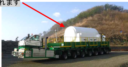
共用プールからキャスク仮保管設備への燃料輸送 東京電力ホールディングス提供資料より
