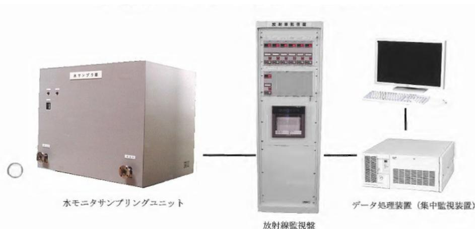
既存の水モニタリング装置(NaI)を用いた場合30分程度の測定時間(測定のためのポンプ揚水時間も含む)で2.5Bq/L検出限界程度の測定感度を得られる。このことから、最速30分ごとの放射能測定を実施して異常値が出た場合に警報するシステムを構築可能。このシステムと従来のゲルマニウム半導体検出装置を用いた定期的な高感度・高精度測定を組み合わせることによって、現実的な上水道の放射性物質モニタリングシステムを構築できると考えられる。
