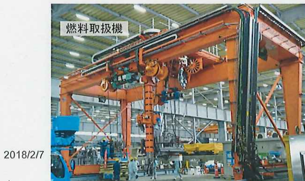
燃料取扱機動作確認状況 (撮影日2017年9月12日)
