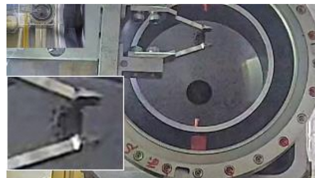
把持したデブリを運搬用ボックスに回収（2024.11.6）
