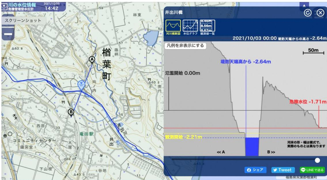
図 井出川に設置された危機管理型水位計
