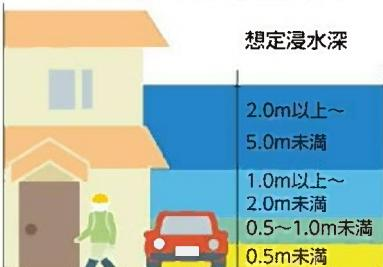
※浸水想定区域は、現在の木戸川の河道整備状況と木戸川ダムの洪水調整等を勘案して、洪水防御に関する計画の基本となる降雨である概ね70年に1度起こる大雨が降ったことにより、木戸川等の河川が氾濫した場合に想定される浸水の状況をシミュレーションにより求めたものです。
