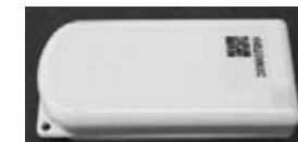
個人線量計（製品名「Dシャトル」） 大きさ・重量：約68mm×32mm×14mm・23g
