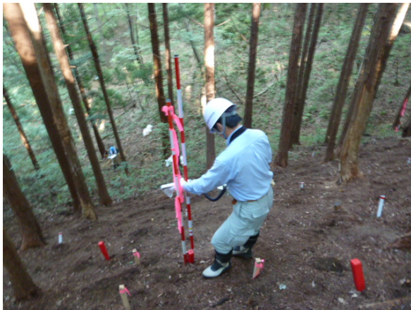
写真5 除去後の空間線量率の測定
